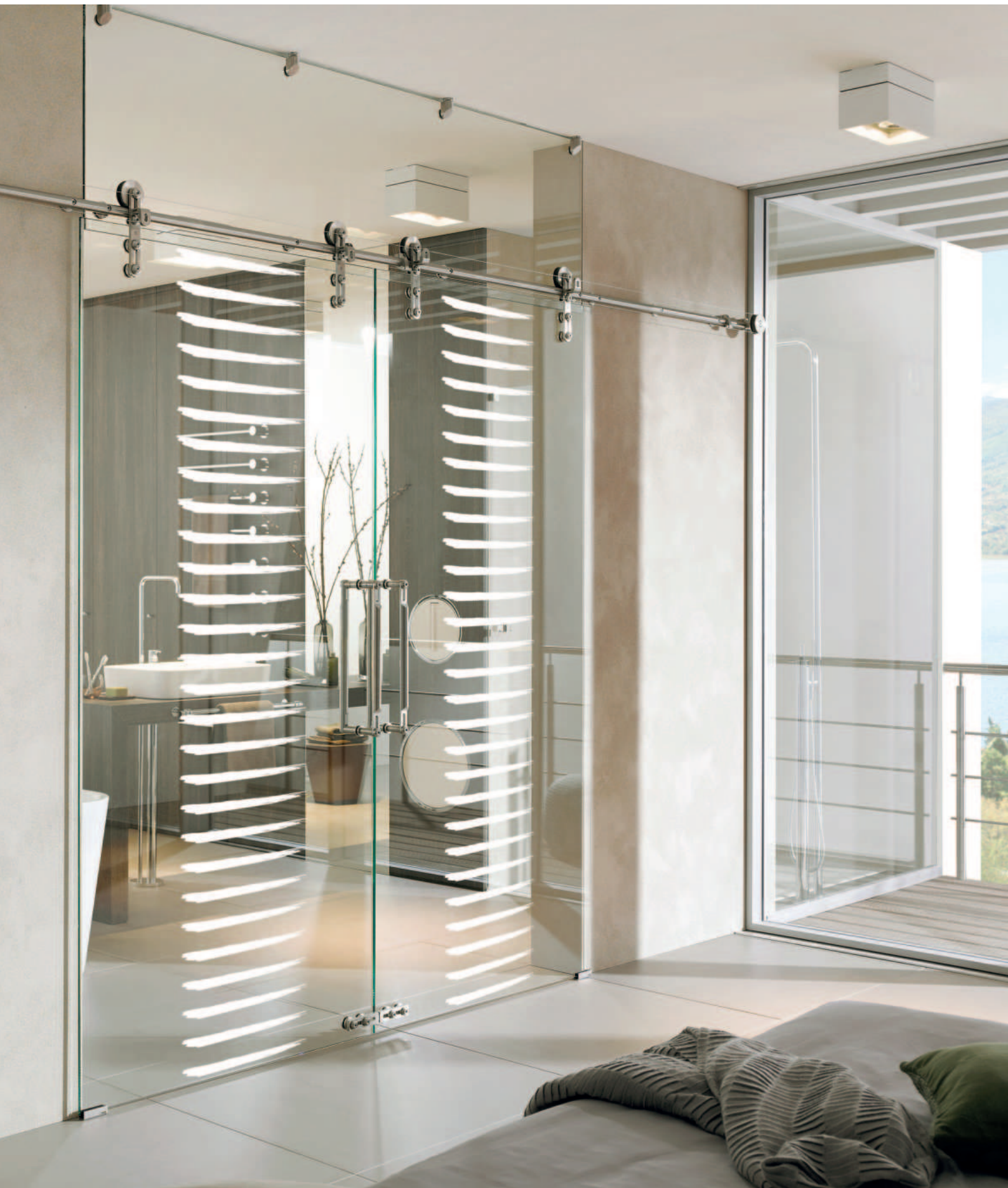
2-flg. Ganzglas-Schiebetürelement vor der Wand laufend; mit Oberlicht mit Synchrotechnik Paint brush (Fläche klar, Motiv matt weiß), Griffstange Protec, Glaspunkthalter und Aufprallschutz Protec
