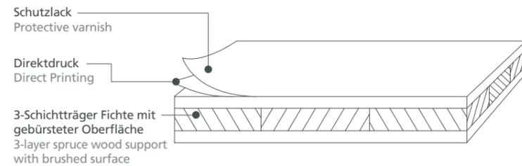
Auf eine gebürstete Fichtendreischichtholzplatte wird ein individuelles Dekor gedruckt und mit einem Schutzlack versiegelt. Durch die gebürstete Holzoberfläche wird das Produkt zu einem haptischen Erlebnis.
