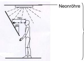
DIN EN 14323 800-1000 LUX , Fehler > 0,8 mm² Test BE/ST/QK Abtesten Tischneigung Abtesten Lampensituation/Lage/Höhe
